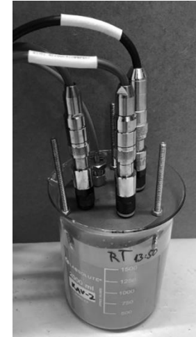
Messung von T , pH, \sigma , sO_2 , E^0 im Becherglas
